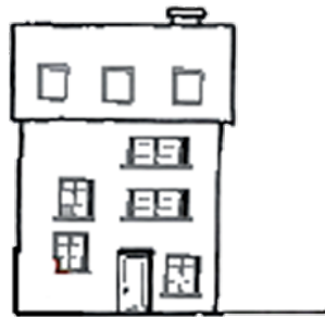
Absence d'ordonnement des baies
